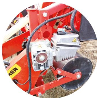
Se puede utilizar PCS 200 incluso en **máquinas de siembra para hortalizas**. Gracias a la posibilidad de **configurar individualmente cada hilera**, es posible aumentar la densidad en las hileras exteriores y obtener, de esta manera, rendimientos mayores.
