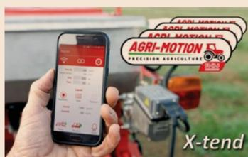
L'app **AGRI-MOTION PCSW1 X-tend** installata sullo smartphone, permette di gestire in wireless la semina e la fertilizzazione di prodotti diversi e su ampiezze maggiori, grazie all'estensione del controllo da 1 fino a 4 motori brushless 12V **DMD-0**. I motori vengono sincronizzati per regolare automaticamente la quantità di semina e la distribuzione in base alla velocità del trattore.
