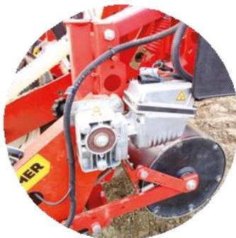
PCS 200 può essere utilizzato anche su macchine di semina per ortaggi. Grazie alla possibilità di configurare individualmente ogni fila, è possibile aumentare la densità sulle file esterne ottenendo così rese più elevate.
